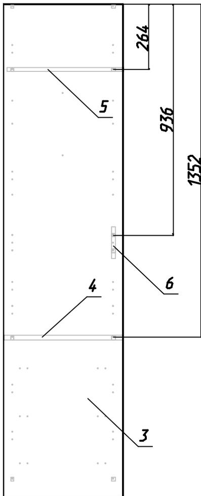
Рис.5 Схема установки деталей 4, 5, 6
