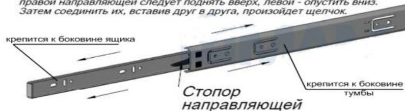
Рис.2 Схема установки шариковых направляющих
