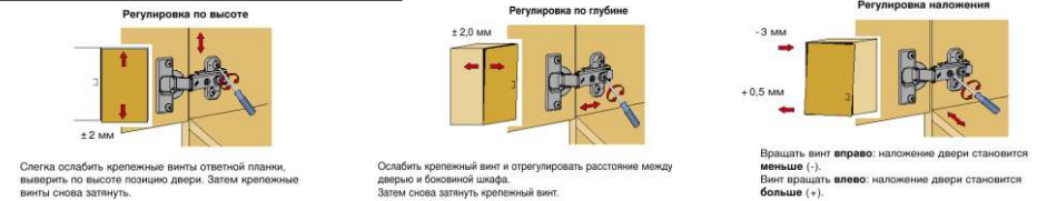
Рис.4 Схема установки подвески
